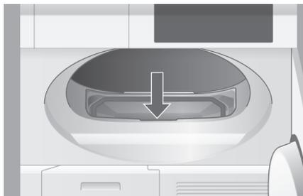
Introduisez le tube de l'aspirateur ou le pinceau de nettoyage dans l'ouverture du filtre à peluches.
