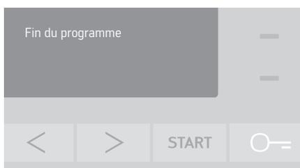
Lorsque la protection anti-froissage est activée, le tambour continu de tourner à intervalles courts à la fin du programme (voir **Réglages / Protection anti-froissage**).
