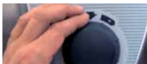
Appuyer sur la touche de température et régler la température d'enceinte
