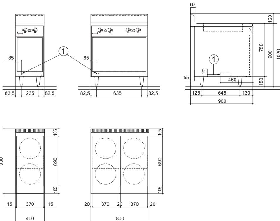
① Raccordement électrique
